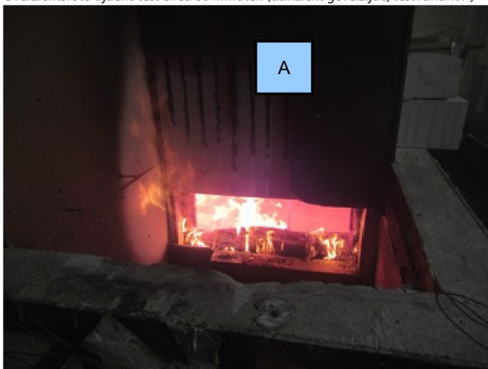
f2.6 Overzichtsfoto tijdens test circa 60 minuten (aanzicht gevelzijde, testvariant A)
