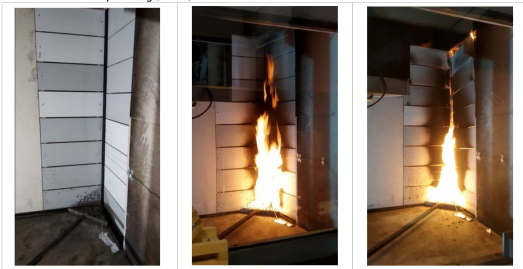
f2.8 Testen met de SBI-opstelling (test 3)
