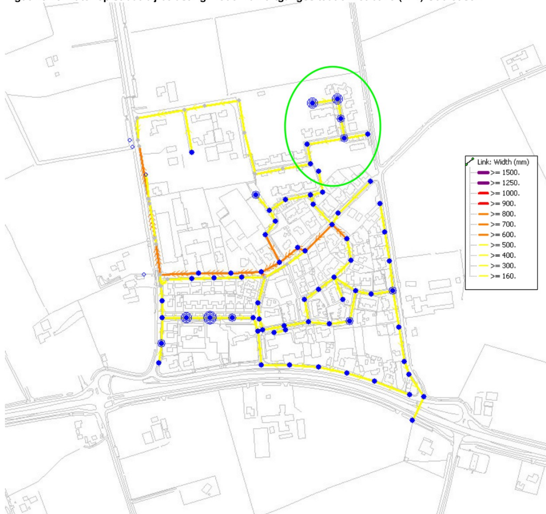
Figuur 6.10 Water op straat bij belasting model van uitgangssituatie met bui 8 (T=2) Oudleusen
