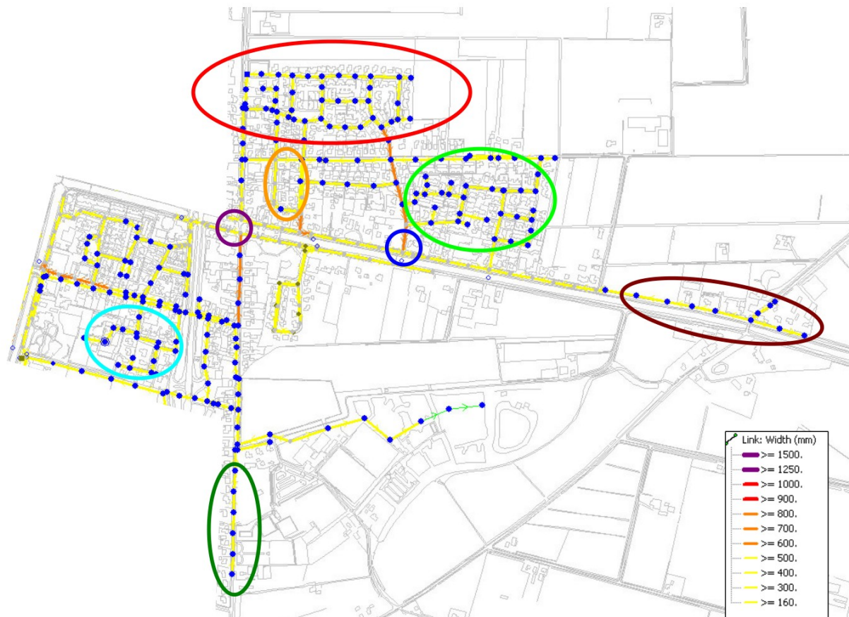
Figuur 6.12 Water op straat bij belasting model van uitgangssituatie met bui 8 (T=2) Lemelerveld
